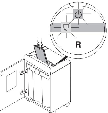
**RUS** При отсутствии бумаги аппарат автоматически останавливается.
